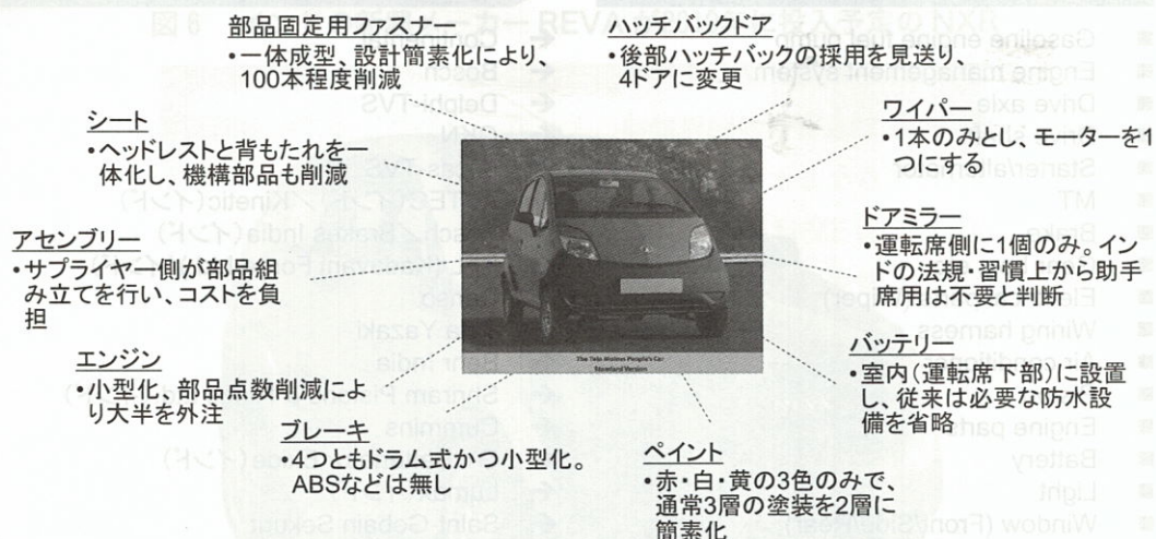
図4 TATA「nano」(スタンダード・グレード)の低価格を実現した徹底的な設計簡素化(一部推定)
